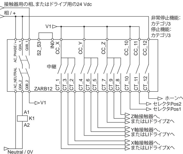
非常停止と停止SIL2、PLd、カテゴリ3、ミックスドライブ、および接触器の配線例
