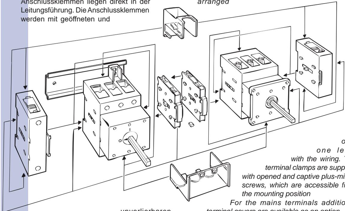
unverlierbaren Plus-Minus-Schrauben geliefert, die aus der Einbauperspektive zugänglich sind. Für Netzeingangsklemmen sind zusätzliche Klemmenabdeckungen als Zubehör lieferbar. Bei Schaltern die als Hauptschalter mit oder ohne Not-Aus Funktion geliefert werden ist diese Abdeckung serienmäßig beigelegt (Typenbezeichnung –HS)
