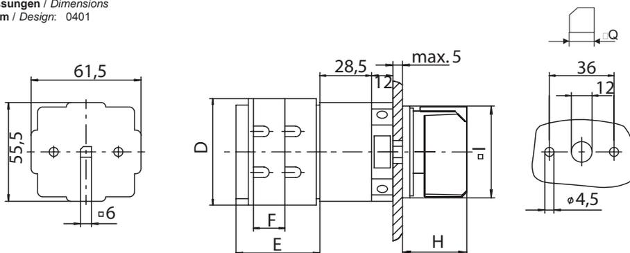
**Unterspannungslöser (gemäß EN60947-1)**
