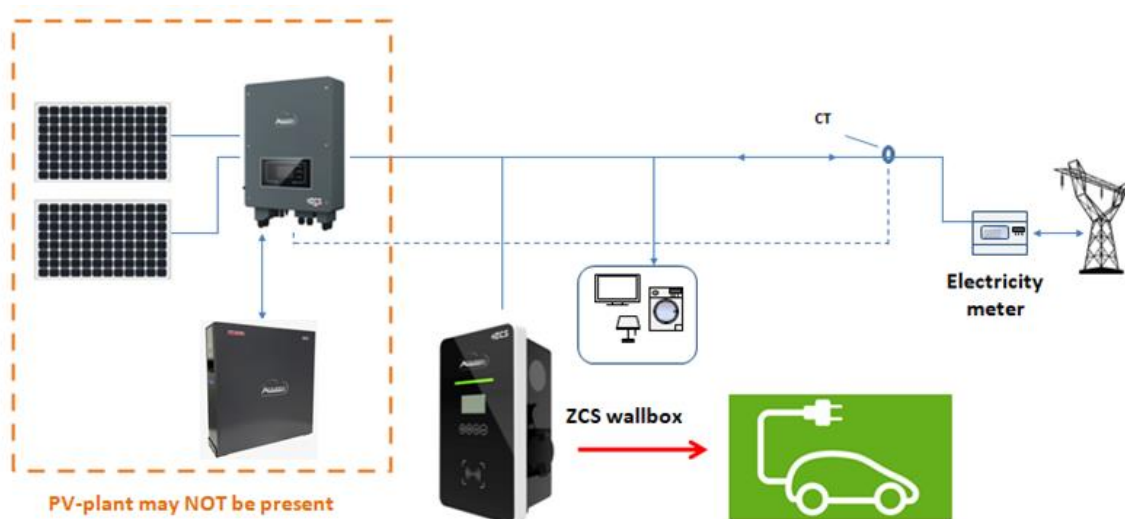
Rysunek 3 - Przykład stacji ładującej podłączonej do sieci PV (opcjonalnie) i sieci
